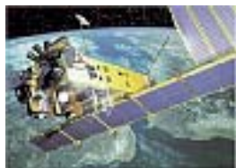
Figur 1. ESA Envisat satellit har 12 instrumenter, vejer 8 tons og har observeret siden år 2003. Kilde ESA.
